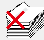
Papier zu dünn – Klammerung trägt auf
